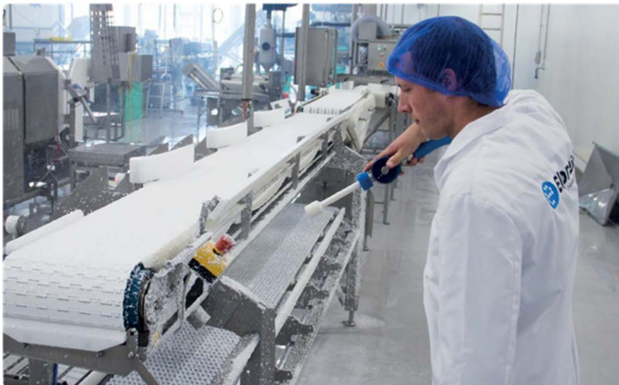
*CF-Q 6E обеспечивает одновременное выполнение процедуры пенообработки для макс. 6 пользователей.*
